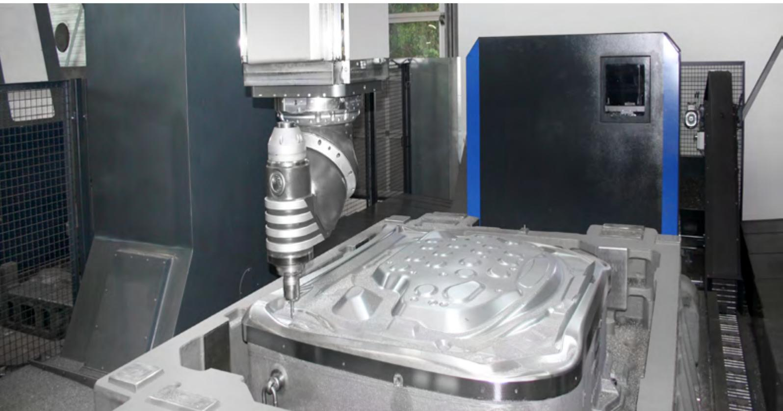
“Cada molde requiere una media de 5 días de pulido en Audi antes de poder instalarlo en la prensa. Estoy entusiasmado con la precisión de la nueva fresadora puente de Soraluze. Es tan precisa, incluso en los en los perfiles de radio, que solo necesitamos 3 días para pulirlo”.
